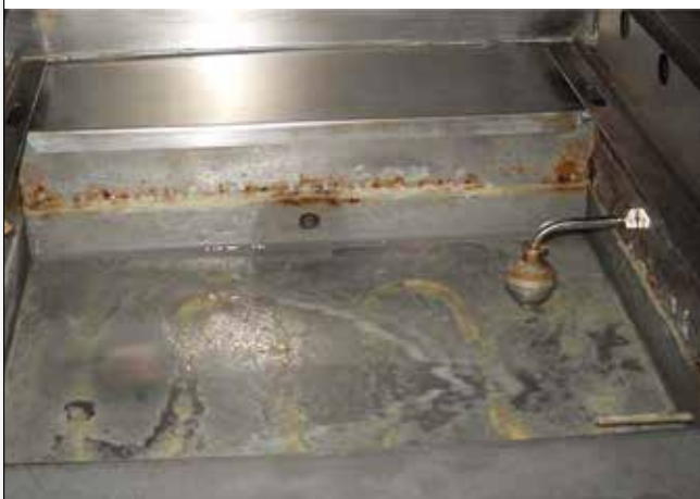
Bac avant l'installation de Vulcan, calcaire dur et ligne gravée entartrée.
